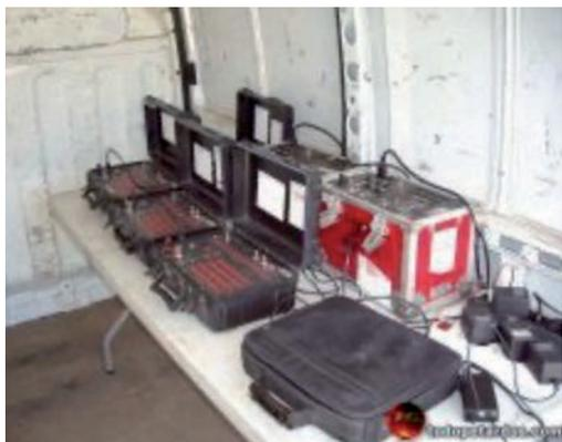
Imagen 15. Sistema de disparo digital de espectáculos pirotécnicos, preparados para su utilización.
