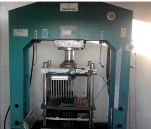
Imagen 18. Detalle de máquina encapsuladora automática, impulsada por aire comprimido.
