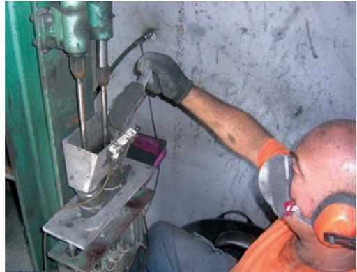
Imagen 20. Detalle de dosificación y pesaje manual de mezcla/materia pirotecnia.
