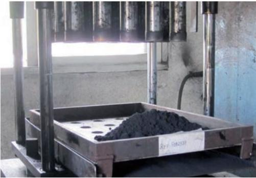
Imagen 33. Prensa fabricación pastillas de color.
