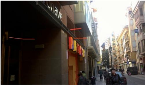
Imagen 21. Detalle de la distancia existente entre las distancias y aperturas de local, locales colindantes, y viviendas existentes en la parte superior. Este establecimiento no pudo llegar a legalizarse por no cumplir la distancia mínima de 1,0 m.
