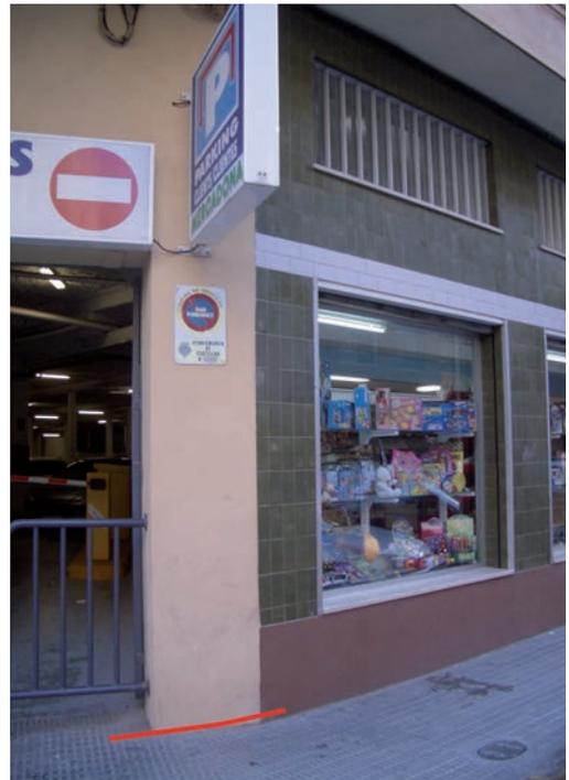
Imagen 24. Detalle de la distancia existente entre las aperturas de local y el local colindante, superándose la longitud de 1,0 m, al formar las fachadas un ángulo comprendido entre 180 y 135 °, según SI 2, art 1.
