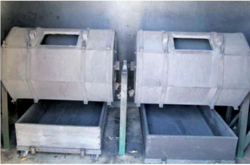
Imagen 32. Bombos de molienda de sección de fabricación de color.
