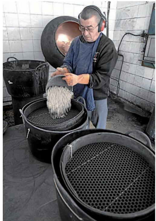
Imagen 31. Procedimiento de cribado de pastillas o bolas de color, después de proceso de fabricación.
