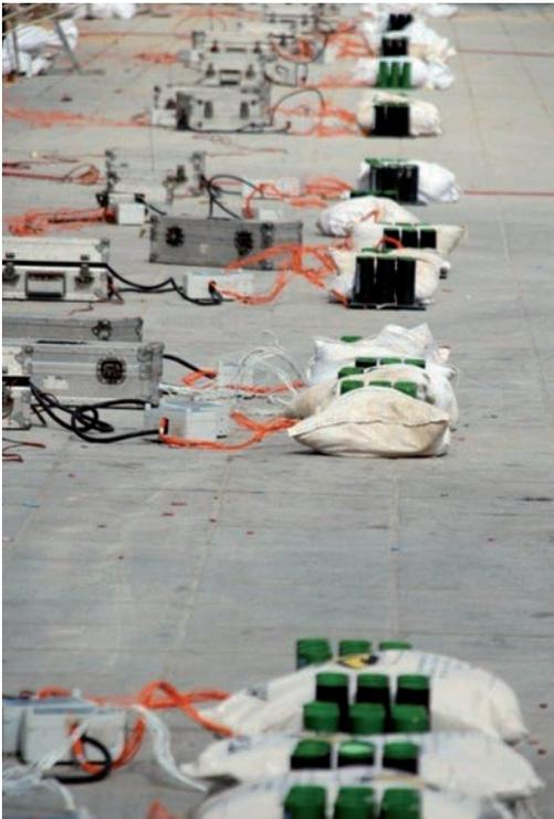
Imagen 19. Detalle de los efectos aéreos. Nótese el lastrado mediante sacos areneros y los elementos de iniciación y secuenciación digital.
