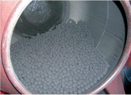
Imagen 16. Detalle bombos de molienda de bolas de color.
