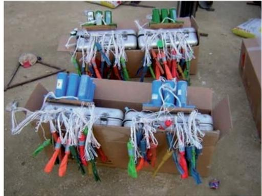
Imagen 20. Detalle de los artefactos aéreos, premontados en espera de ser emplazados en lugar de lanzamiento. Con esta práctica, se han producido algunos accidentes durante la manipulación por errores de funcionamiento de los elementos de iniciación.
