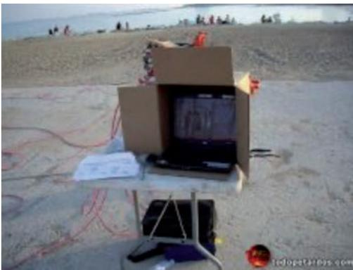
Imagen 18. Sistema de disparo digital de espectáculos pirotécnicos, preparados para su utilización.
