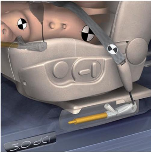
Imagen 20. Sistemas pirotécnicos en elementos de protección activa en automóviles. Pretensores de cinturones de seguridad.
