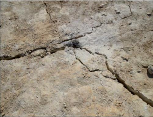
Imagen 3. Detalle fracturación de macizo por efecto de los gases de la deflagración confinada.
