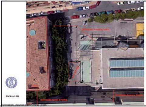
Imagen 21. Plano de cumplimiento de distancias a edificaciones, viales, etc de espectáculo con NEC< 10 kg.
